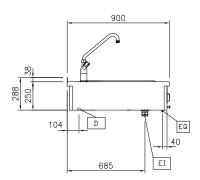
FΙ Electrical inlet (power) Equipotential screw EQ Water inlet
